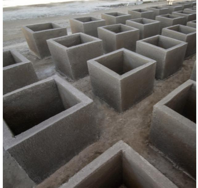
São soluções versáteis e funcionais para sistemas de redes hidrossanitárias, podendo ser aplicadas tanto em redes cloacais (esgoto sanitário) quanto em redes pluviais (água da chuva).
