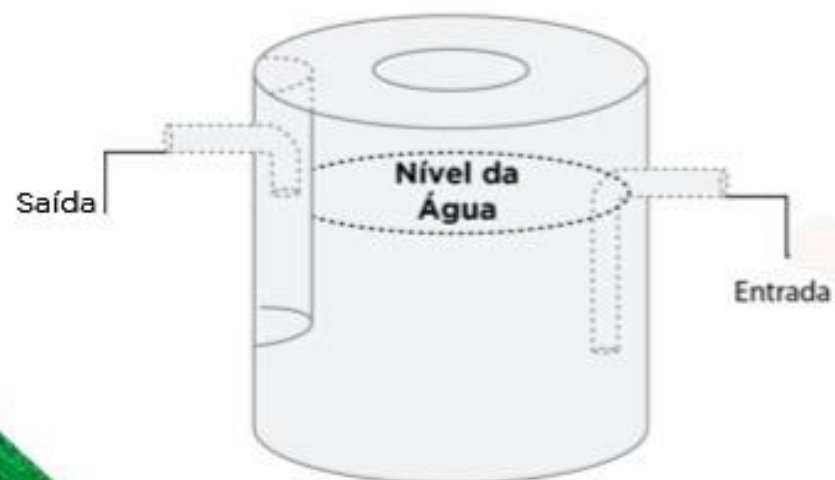
*SIFÃO EM CONCRETO ARMADO
